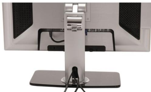
Después de conectar todos los cables necesarios al monitor y al ordenador (consulte [Conexión del monitor](#) para conectar los cables), utilice el orificio de gestión de los cables para organizar todos los cables como se muestra arriba.
